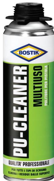
Rimuovere l'ugello rosso e girare Bostik PU Cleaner dal basso verso l'alto sulla pistola PUR. Tirare il grilletto per alcuni secondi. Scuotere la pistola PUR con Bostik PU Cleaner per 10 durante l'erogazione. Ripetere quest'operazione finché dalla pistola PUR fuoriesce un liquido trasparente.
